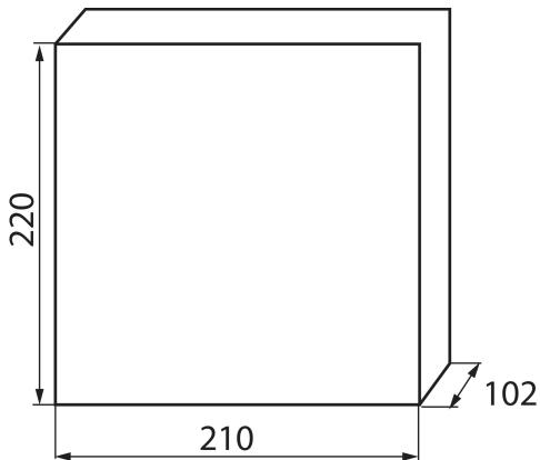
Quadri elettrici della serie KDB che soddisfano il requisito della resistenza al calore con temperatura a 650°C possono essere utilizzati esclusivamente su superfici incombustibili (ad esempio pareti solide realizzate in materiali non infiammabili). Non possono essere applicati su superfici infiammabili (ad esempio cartongesso, legno), su cosiddette "pareti vuote" o su cavedi tecnici.
