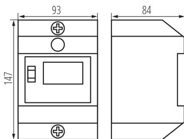
Alloggiamento per interruttori di protezione del motore, grado di protezione IP65. L'alloggiamento ospita un interruttore di protezione del motore, un modulo largo 17,5 mm e un modulo largo 8,75 mm. L'alloggiamento è dotato di sportelli trasparenti per il comando dei pulsanti dell'interruttore.
