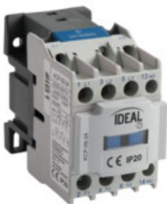
I contatti di potenza sono progettati per collegare circuiti di corrente alternata in classe di utilizzo AC3. Range di corrente fino a 32A, tensione di alimentazione 24VAC o 230VAC. I contatti sono dotati di serie di un contatto ausiliario 1NO.
