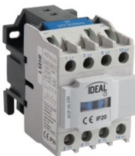
I contatti di potenza sono progettati per collegare circuiti di corrente alternata in classe di utilizzo AC3. Range di corrente fino a 32A, tensione di alimentazione 24VAC o 230VAC. I contatti sono dotati di serie di un contatto ausiliario 1NO.
