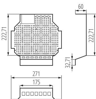
Le schede multimediali KDB-S / F sono una soluzione che permette di trasformare quadri elettrici in quadri (multimediali) teletecnicici. È sufficiente rimuovere le guide DIN e inserire al loro posto un disco multimediale. Questo vale per i quadri KDB a due file per 12 e 18 moduli (sia da incasso che da parete).
