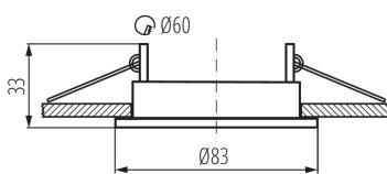
Kanlux ALOR è una collezione di faretti incasso ricca di colori. Sono gli spot più diffusi da soffitto di diametro 8,3 cm. Questi spot non sono dotati della presa in ceramica. Sono compatibili con portalamapda GU10 oppure Gx5,3.
