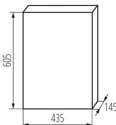
Quadri elettrici della serie KDB che soddisfano il requisito della resistenza al calore con temperatura a 650°C possono essere utilizzati esclusivamente su superfici incombustibili (ad esempio pareti solide realizzate in materiali non infiammabili). Non possono essere applicati su superfici infiammabili (ad esempio cartongesso, legno), su cosiddette "pareti vuote" o su cavedi tecnici.
