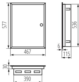
I quadri KP-DB con guide DIN per l'installazione di apparecchiature modulari sono prodotti nello stabilimento della Kanlux. Sono destinati a edifici pubblici ed uffici ma loro campo di applicazione si estende anche ad usi domestici
