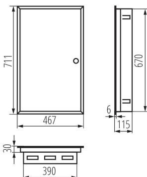
I quadri KP-DB con guide DIN per l'installazione di apparecchiature modulari sono prodotti nello stabilimento della Kanlux. Sono destinati a edifici pubblici ed uffici ma loro campo di applicazione si estende anche ad usi domestici
