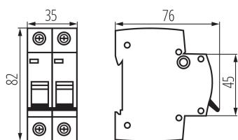
Interruttore automatico magnetotermico: utilizzato per la protezione da sovraccarichi e cortocircuiti.
