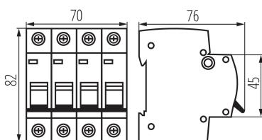
Interruttore automatico magnetotermico: utilizzato per la protezione da sovraccarichi e cortocircuiti.
