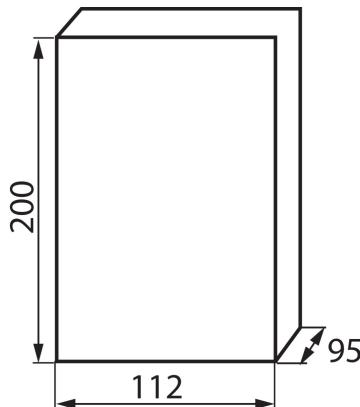
Quadri elettrici della serie DB che soddisfano il requisito della resistenza al calore con temperatura a 650°C possono essere utilizzati esclusivamente su superfici incombustibili (ad esempio pareti solide realizzate in materiali non infiammabili). Non possono essere applicati su superfici infiammabili (ad esempio cartongesso, legno), su cosiddette "pareti vuote" o su cavedi tecnici.
