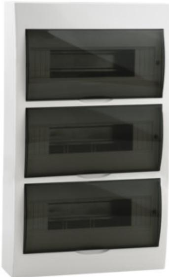
Quadri elettrici della serie DB che soddisfano il requisito della resistenza al calore con temperatura a 650°C possono essere utilizzati esclusivamente su superfici incombustibili (ad esempio pareti solide realizzate in materiali non infiammabili). Non possono essere applicati su superfici infiammabili (ad esempio cartongesso, legno), su cosiddette "pareti vuote" o su cavedi tecnici.
