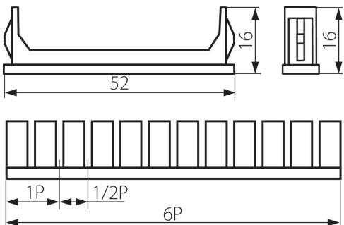
Il coperchio di chiusura per quadri elettrici serve per camuffare spazi non utilizzati. Nel kit sono inclusi due coperchi 1P (17,5mm) e otto coperchi 0,5P (8,75mm).
