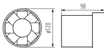
La serie di ventilatori WIR è disponibile in tre misure di diametro diverse: da 100, 120 e 150 mm. Sono realizzati in plastica bianca. La loro potenza è rispettivamente di 19, 20 e 22W. Il numero di giri per ogni tipo è di 2550 giri/min.
