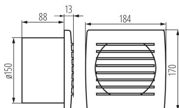
La serie di ventilatori Kanlux CYKLON EOL è disponibile in tre misure di diametro diverse: da 100, 120 e 150 mm. Sono realizzati in plastica bianca. La loro potenza è rispettivamente di 19, 20 e 22W. Il numero di giri per ogni tipo è di 2550 giri/min.
