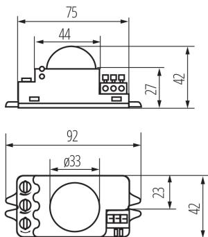
Kanlux ROLF JQ è un sensore del movimento a microonde. Il suo angolo orizzontale d'esercizio è di 360 gradi. È possibile regolare sia il tempo di illuminazione che il livello di illuminamento esterno a cui il sensore funziona.
