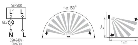
Kanlux MARID JQ è il sensore di movimento con un campo massimo di rilevamento del movimento pari a 12 metri. È possibile regolare sia il tempo di illuminazione che il livello di illuminamento esterno a cui il sensore funziona. Il sensore può essere attivato anche tramite un segnale acustico.
